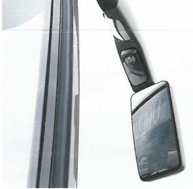
Dreiteilige Rückspiegel mit integrierten Nahsichtspiegeln sorgen für ausgezeichnete Rundumsicht.
