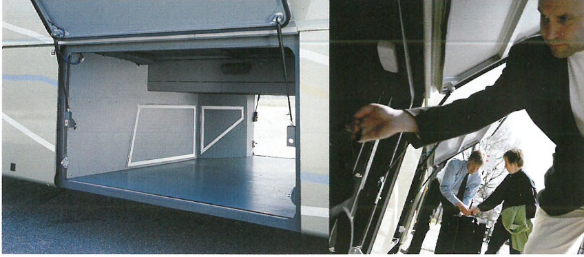
Der Volvo 8700 hat Platz für bis zu 9,5 m³ Gepäck – je nach Modellvariante.
