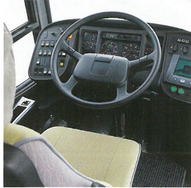
Der Fahrerplatz ist ergonomisch optimal gestaltet – ausgestattet mit verstellbarem Lenkrad und einer Armaturentafel, die automatisch zusammen mit dem Lenkrad verstellt wird.
