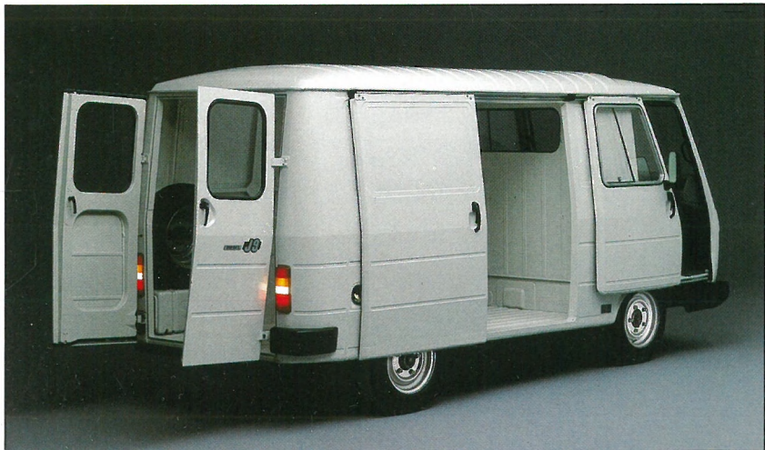
Fourgon tôlé options porte latérale coulissante, portes arrière battantes, cloison de cabine.
