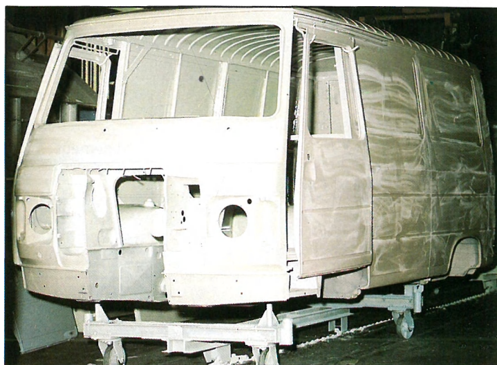
6) APPRÊT : une couche d'apprêt spécial souple de 40 microns assure la résistance antigravillonnage de la laque.
