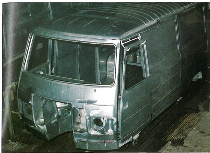
2) PHOSPHATATION : avant peinture, la caisse est dégraissée et phosphatée pour permettre l'accrochage parfait du film de résine dans le bain de cataphorèse.
