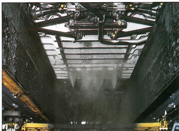
9) CIRE EPAISSE : projetée sur le sous-châssis, elle évite les infiltrations d'eau et d'humidité vers l'intérieur des corps creux.
