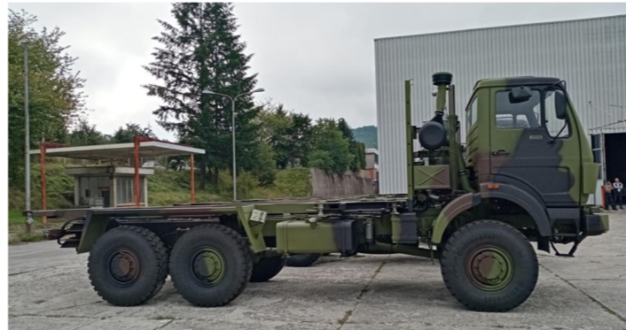
FAP 2228 BS/AV, 6x6 šasija sa kontejnerskim bravama za prihvat kontejnera
