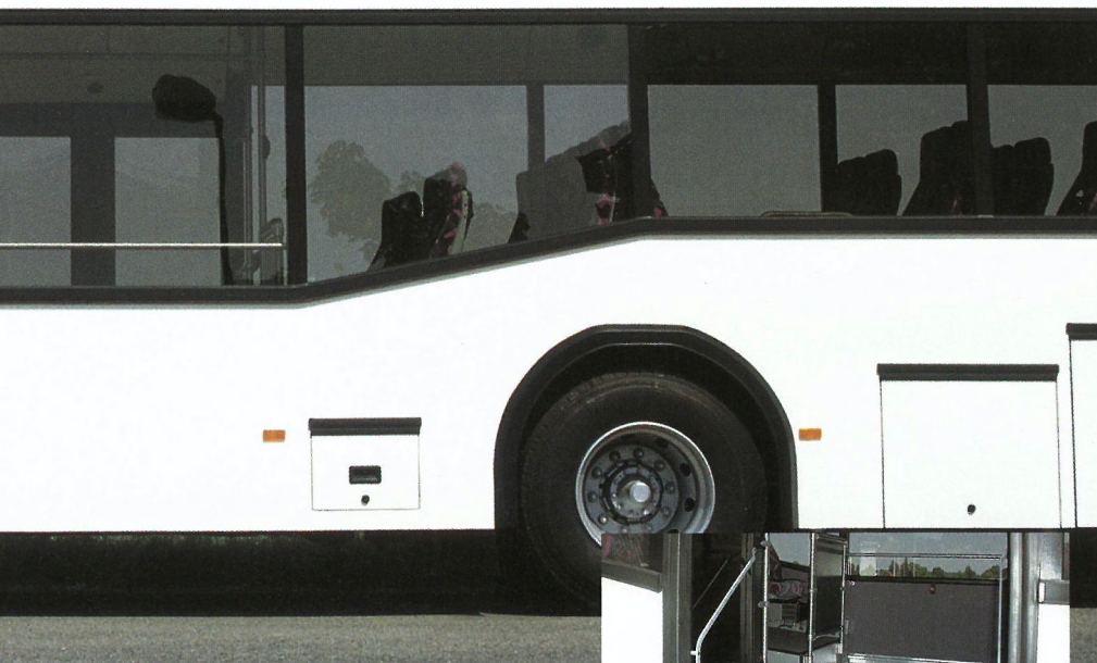
Niedriger und bequemer Einstieg. Kneeling-Funktion von max 120 mm.
